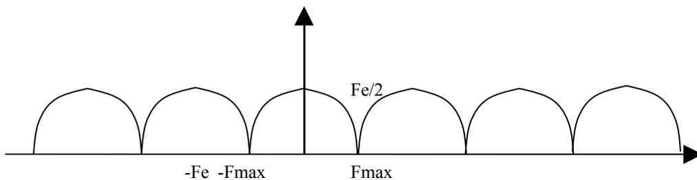
Les spectres sont contigus. Le spectre autour de  $F_e$  ne vient pas perturber le spectre autour de 0, il n'y a pas d'interférence mais on est à la limite
