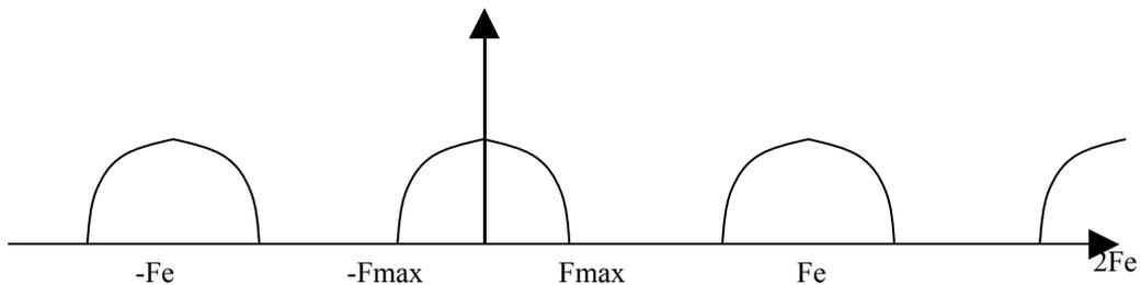
Les spectres sont correctement séparés. Le spectre autour de  $F_e$  ne vient pas perturber le spectre autour de 0, il n'y a pas d'interférence.
