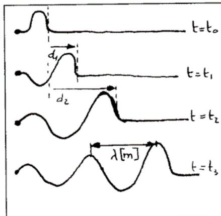
Figure 4 : Evolution de l'amplitude de l'onde en fonction de la distance à différents instants
