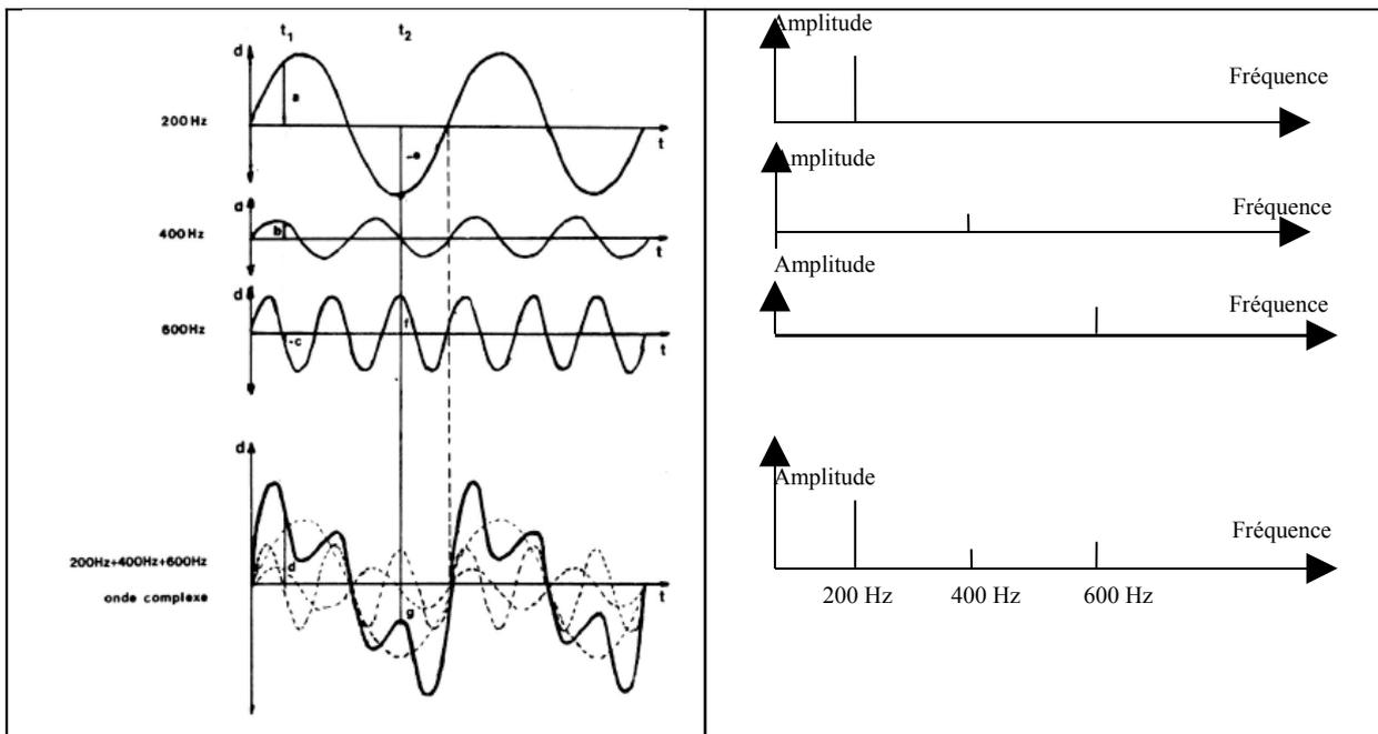
Figure 8 : Représentation temporelle et spectrale d'un signal composé de trois fréquences
