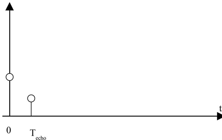
Une brève note représentera une impulsion (un dirac temporel), et nous avons donc tracé sur la figure précédente la réponse du canal. Le signal entendu et l'écho atténué à l'instant  $T_{\text{echo}}$ .
