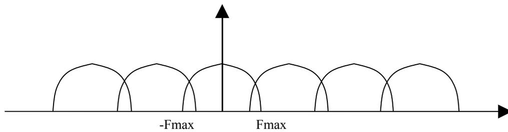
Les spectres se chevauchent, il y a une perturbation appelé bruit de repliement.
