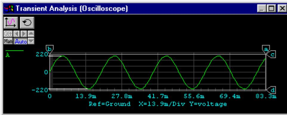
Figure 7 : Représentation à l'oscilloscope de la tension secteur
